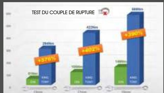
Résultat du test réalisé par la CETIM (organisation de certification indépendante). Test du couple de rupture des clés mixtes KING TONY® 13, 17, et 19 mm. en comparaison avec la norme DIN 3113.
