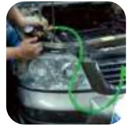
Permet un changement rapide du liquide de refroidissement sous vide.
