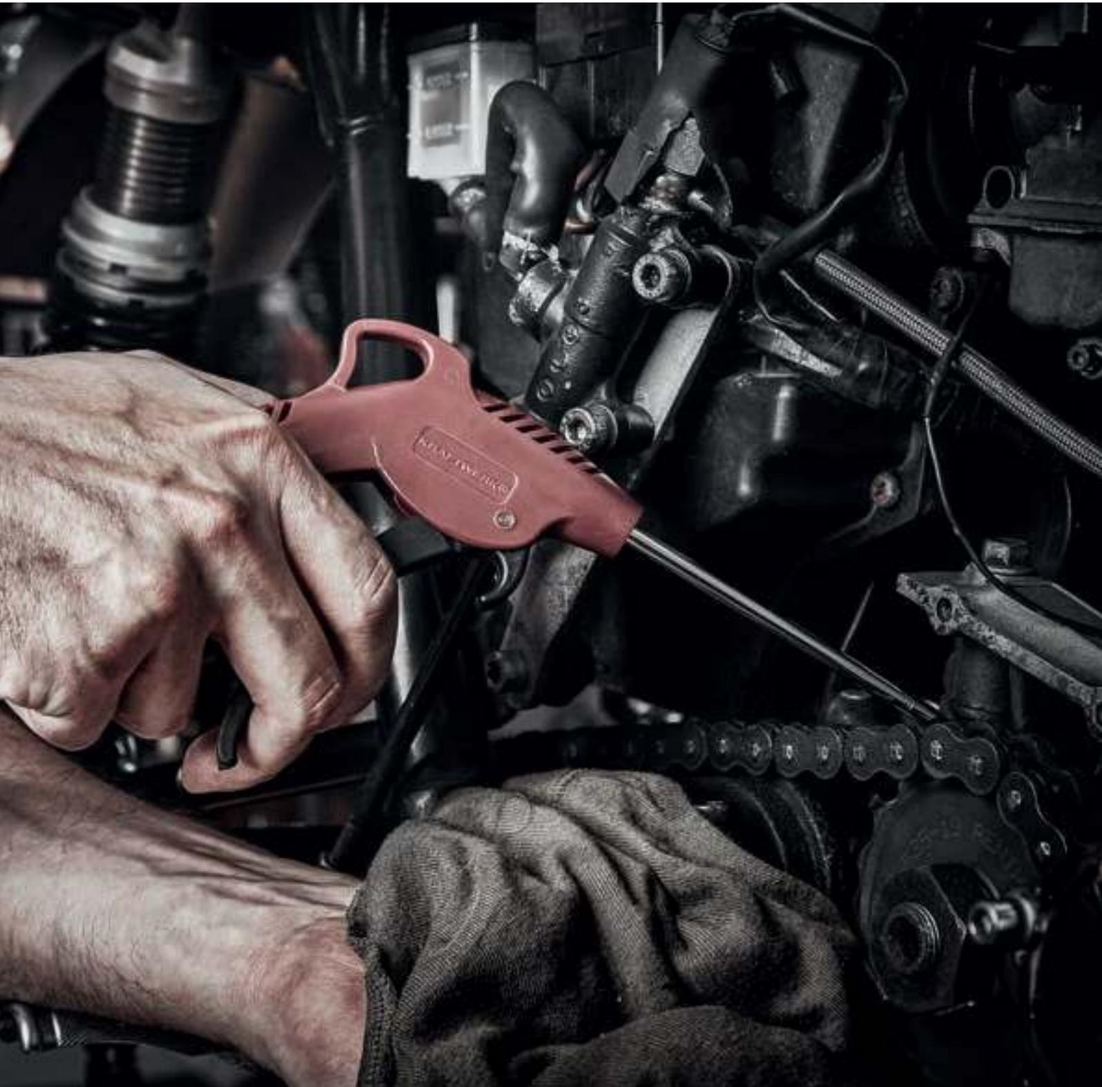
**6.1. PNEUMATIQUE****Soufflette à air comprimé**
